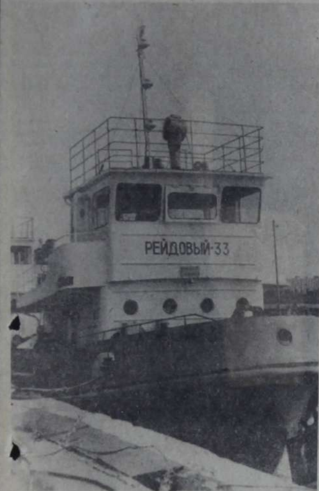
Не один год на судоремонтном заводе спускают на воду рейдовые буксиры. Судостроители хорошо освоили производство малых судов ледокольного типа, которые так необходимы для работы на рейдах.
